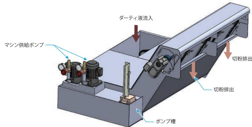
②パンチングフィルターで捕捉された切粉はかき板でかき落され、コンベヤ底に沈殿。スクレーパーで排出されます。
