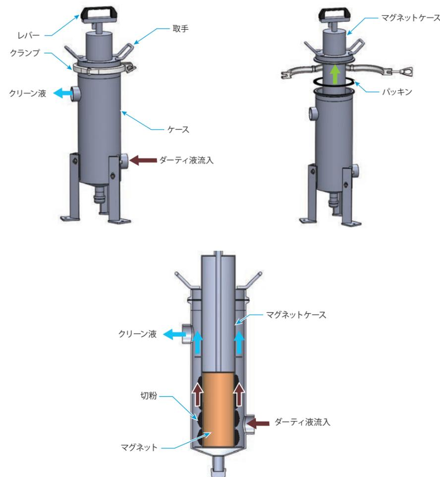
② 切粉・スラッジは任意のタイミングで回収。クランプとパッキンを取り外し、取っ手を持ち上げて本体をケースから取り出します。レバーを引くことで本体からスラッジが落下します。
