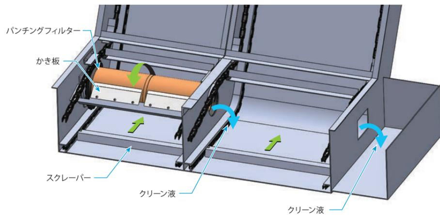
③パンチングフィルターコンベヤで1次濾過されたクリーン液はスクレーパーコンベヤに流入します。
