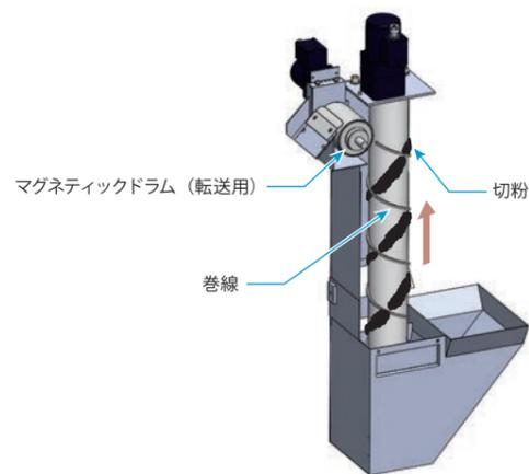
④ 切粉は排出口付近でパイプからマグネティックドラム（転送用）に飛び移り、排出されます。
