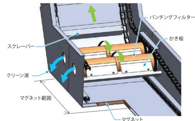
④ パンチングフィルターに捕捉された切粉はかき板でかき落され、コンベヤ底に沈殿します。
