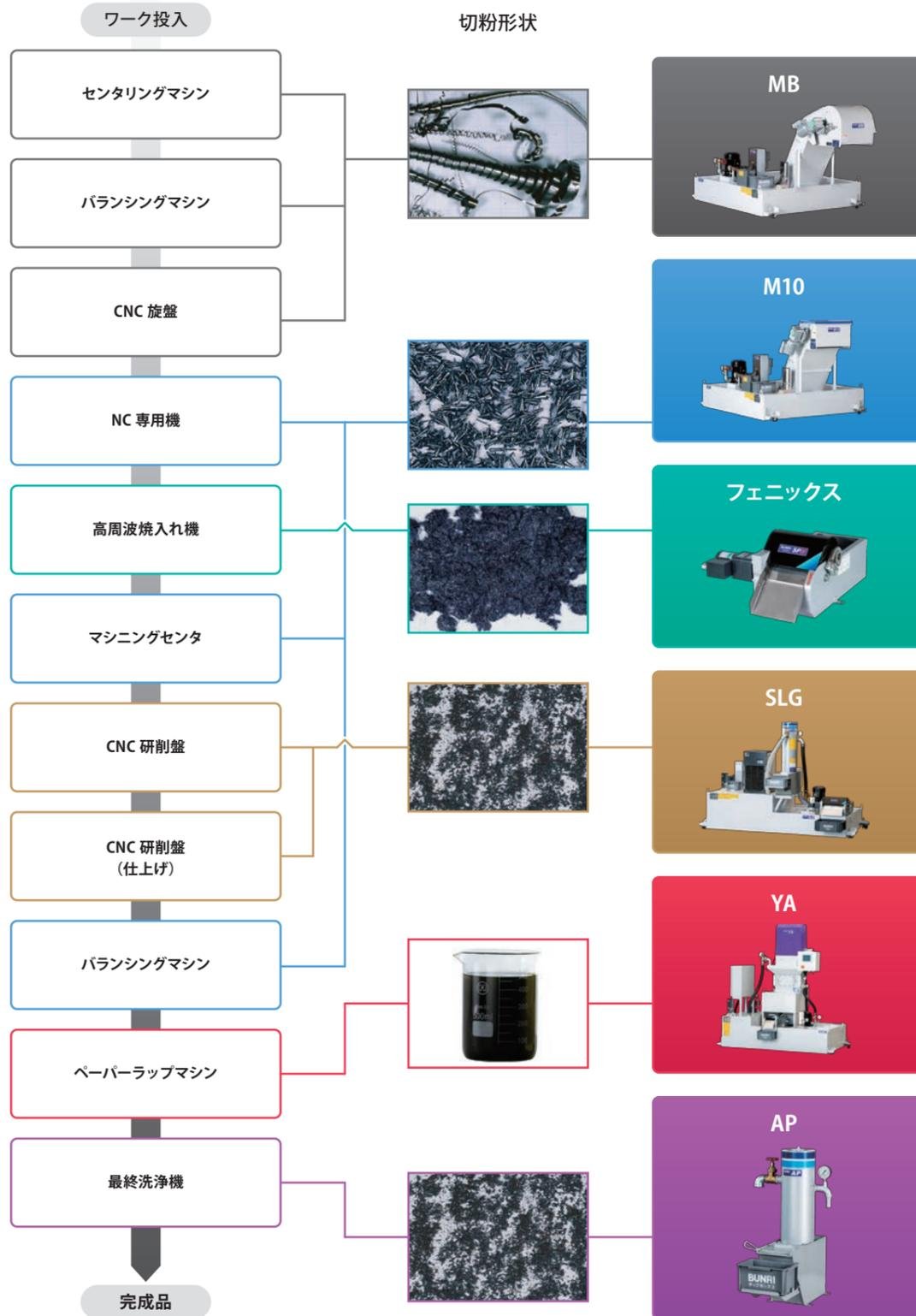
非磁性体例 製品モデルライン：(例) シリンダーヘッド加工ライン
