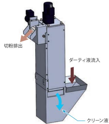
② 切粉は固定したパイプ内部のマグネットにより吸着して捕捉されます。
