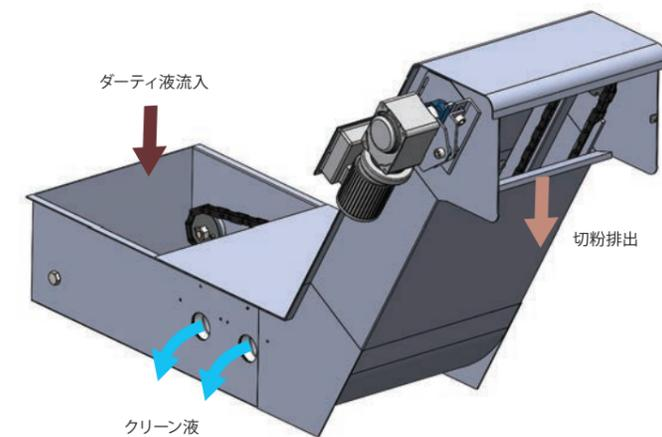
③パンチングフィルターに捕捉された切粉はかき板でかき落され、コンベヤ底に沈殿します。
