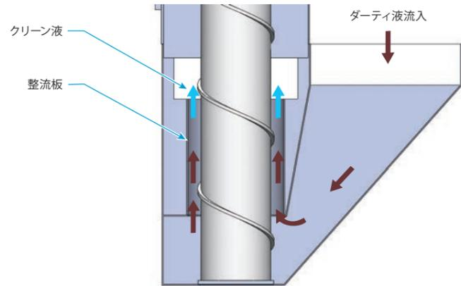
③ 内部のマグネット軸が回転することで、切粉はパイプの表面を移動しながら本体上部に運搬されます。その際、巻線は運搬の補助を行います。
